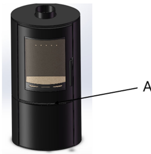
A- Δευτερεύουσα και τριτογενής θέση ελέγχου αέρα
